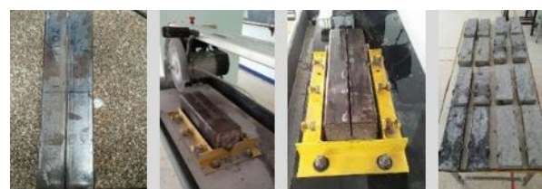
(ก) ผ่าปลอกเหล็ก (ข) ยึดตัวอย่างกับเครื่องตัด (ค) ผ่าตัดตัวอย่าง (ง) ตัวอย่างที่ผ่าตัดแล้ว
