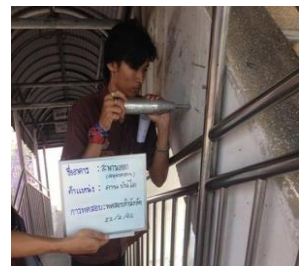
รูปที่ 2 วิธีการทดสอบกำลังอัดประลัยของโครงสร้างคอนกรีต โดยใช้ค้อนกระทบแบบชมิทท์
