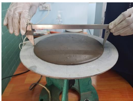
รูปที่ 2 การทดสอบค่าไหลแผ่ของจีโอโพลิเมอร์มอร์ตาร์
