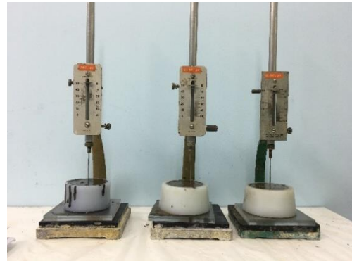
รูปที่ 3 การทดสอบระยะเวลาการก่อตัวของจีโอโพลิเมอร์มอร์ตาร์
