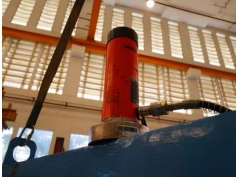
รูปที่ 6 โหลดเซลล์ ขนาด 20 tons พร้อมชุดไฮดรอลิก
