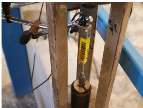
รูปที่ 7 ติดตั้ง LVDT บนหัวเหล็ก DB12
