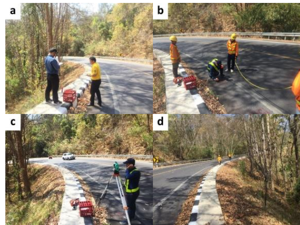
รูปที่ 2 แสดงการสำรวจพื้นที่ (a)เก็บข้อมูล, (b)วัดระยะพื้นที่, (c)การหาค่าพิกัดตำแหน่ง, (d)พื้นที่สำรวจ
