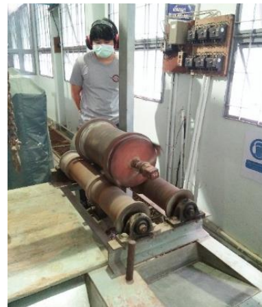
รูปที่ 1 การบดดินเม็ดละเอียดอบแห้งด้วยเครื่อง Batch Rod Mill
