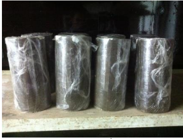
รูปที่ 1 ลักษณะการบ่มคอนกรีตที่อุณหภูมิห้องควบคุมรูปที่ 1 วิธีเตรียมตัวอย่างคอนกรีตที่มีการแข็งตัวเร็ว
