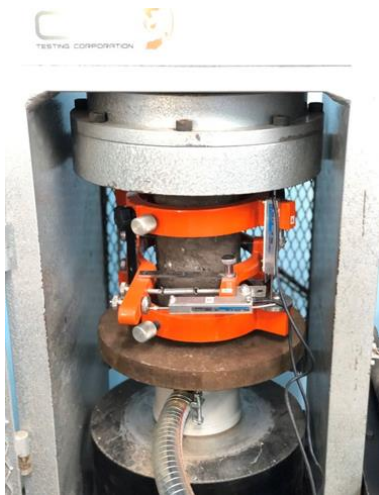
รูปที่ 2 การทดสอบกำลังอัด โมดูลัสยืดหยุ่นและอัตราส่วนปัวซองของคอนกรีตที่มีการแข็งตัวเร็ว
