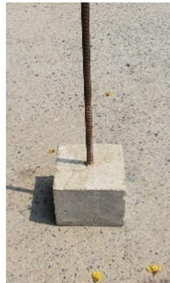
รูปที่ 3 ทรงลูกบาศก์ขนาด 15 x 15 x 15 เซนติเมตร
