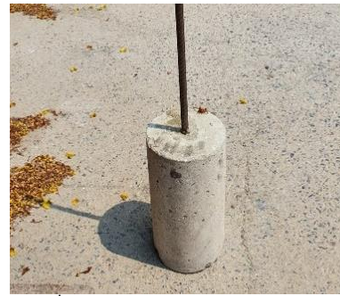
รูปที่ 2 ทรงกระบอก \phi 15 สูง 30 เซนติเมตร
