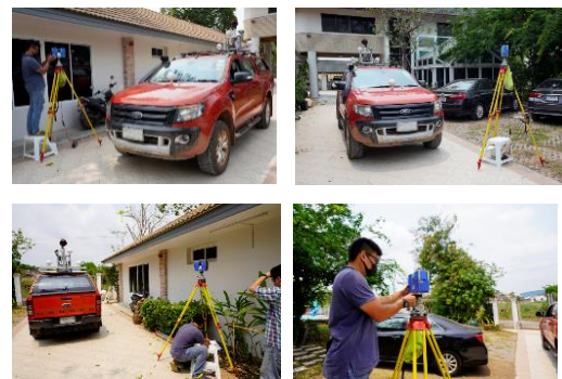
รูปที่ 4 แสดงการติดตั้งที่เป้าตำแหน่งต่างๆ และการสอบเทียบด้วย Laser Scanner
