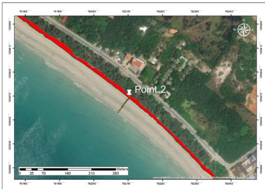
จุดสำรวจที่ 2 พื้นที่สะสมตัว 0 ตร.ม พื้นที่กัดเซาะ 7,033.25 ตร.ม.
