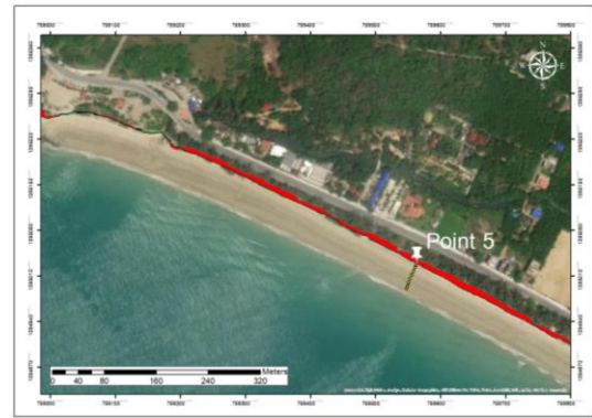
จุดสำรวจที่ 5 พื้นที่สะสมตัว 198.009 ตร.ม พื้นที่กัดเซาะ 7,357.503 ตร.ม.
