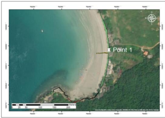
จุดสำรวจที่ 1 พื้นที่สะสมตัว 867.591 ตร.ม พื้นที่กัดเซาะ 50.62 ตร.ม.
