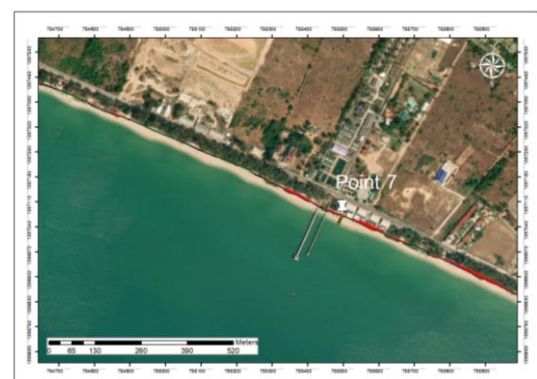
จุดสำรวจที่ 7 พื้นที่สะสมตัว 1,347.431 ตร.ม พื้นที่กัดเซาะ 3,623.046 ตร.ม.
