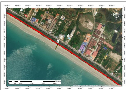
จุดสำรวจที่ 3 พื้นที่สะสมตัว 0 ตร.ม พื้นที่กัดเซาะ 7,971.245 ตร.ม.
