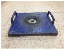
รูปที่ 2 แผ่นเหล็กทดสอบรูปสี่เหลี่ยมตามมาตรฐาน มทข.105-2545
