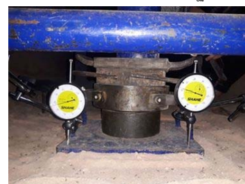
รูปที่ 6 การทดสอบ Plate Bearing Test ในสนาม
