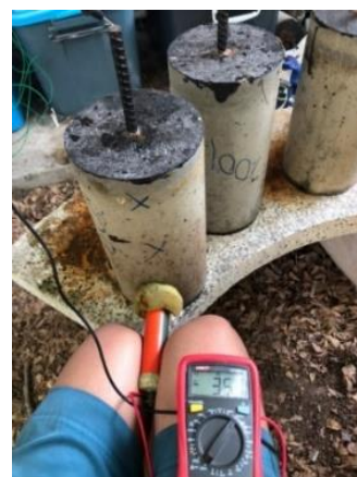
รูปที่ 1 ตัวอย่างการทดสอบตามมาตรฐาน ASTM C876 [12]
