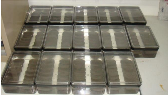
รูปที่ 2 ชั้นตัวอย่างทดสอบ 14 ส่วนผสมที่แช่ในสารละลายโซเดียมคลอไรด์
