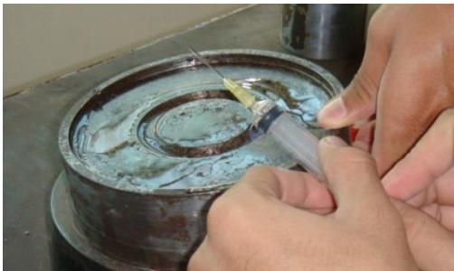
(ข) สารละลายที่ถูกรีดออกจากโพรงของชิ้นตัวอย่างเพสต์
