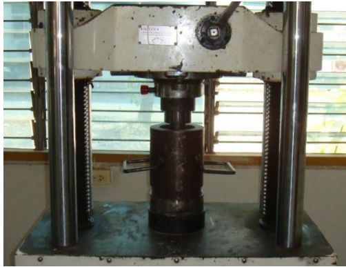
(ก) การติดตั้งเครื่องมือรีดสารละลาย
