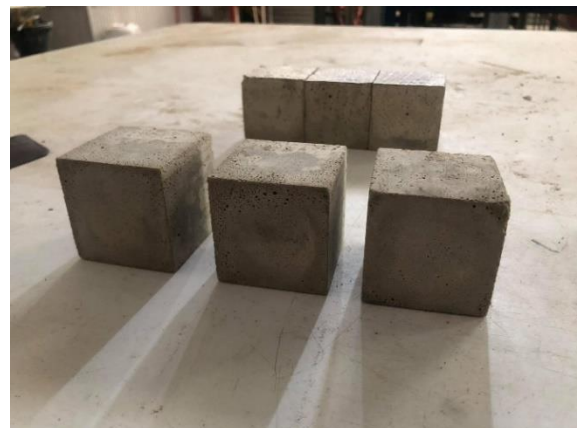
รูปที่ 11 ก้อนตัวอย่างคอนกรีตเมื่อแทนที่ด้วยกากปูนขาว
