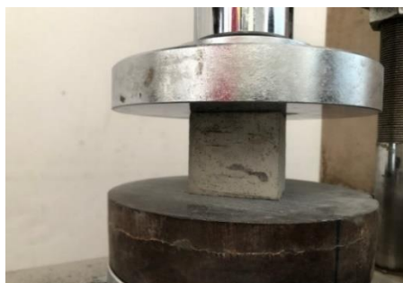
รูปที่ 5 การทดสอบกำลังรับแรงอัด
