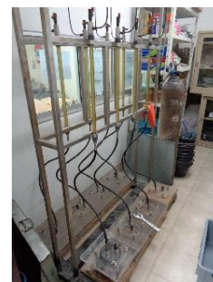
รูปที่ 3 การทดสอบการซึมผ่านน้ำของคอนกรีต
