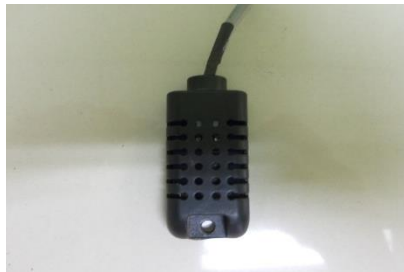
ง) ติดตั้งเซ็นเซอร์วัดอุณหภูมิและความชื้น
