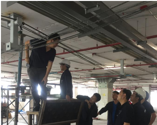
รูปที่ 13 การตรวจวัดการสั่นสะเทือนของพื้น
