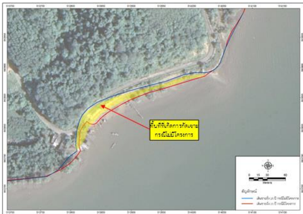
รูปที่ 6 การคาดการณ์แนวเปลี่ยนแปลงชายฝั่งในอนาคต (25 ปี) ด้วยแบบจำลองคณิตศาสตร์ LITPACK
