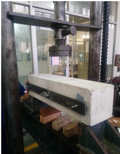
รูปที่ 2 การติดตั้งคานที่มีรอยบากสำหรับทดสอบ
