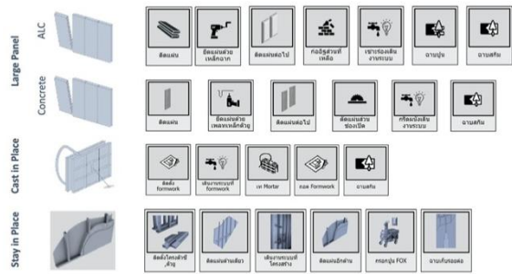
รูปที่ 3 การติดตั้งของวัสดุก่อผนัง
