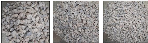
รูปที่ 1 มวลรวมหยาบรีไซเคิล (ก) หินขนาด 1/2 นิ้ว (ข) หินขนาด 3/8 นิ้ว (ค) หินเบอร์ 4
