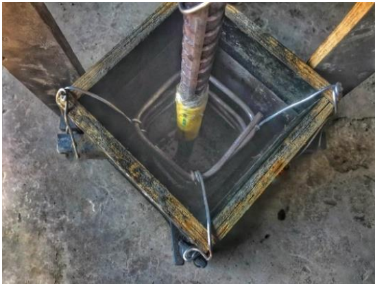
รูปที่ 2 การติดตั้งเหล็กปลอกในก้อนตัวอย่าง
