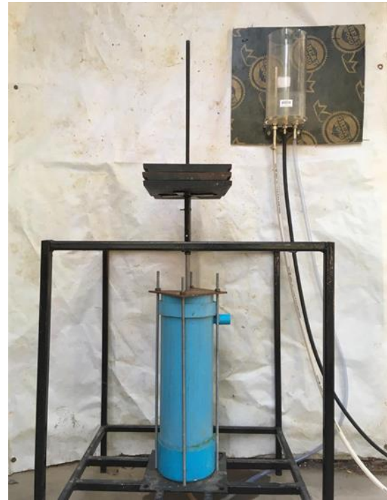
รูปที่ 3 การทดสอบค่าสัมประสิทธิ์การซึมผ่านได้ของเศษยางรถยนต์เก่าที่มีหน่วยแรงกดทับในขณะทดสอบ
