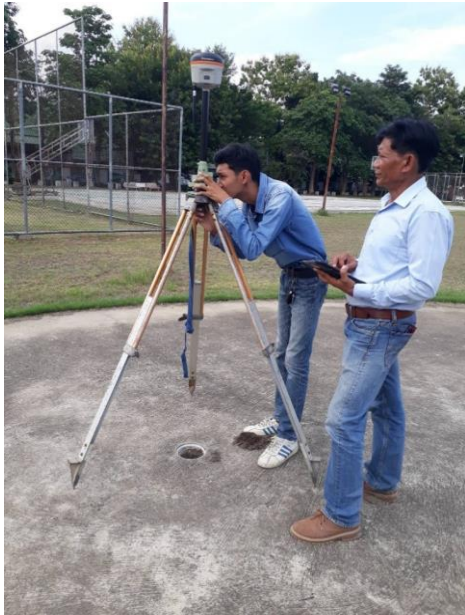
รูปที่ 5 ตั้งเครื่องรับสัญญาณดาวเทียมเหนือสถานีจริง หมุดGPS3487
