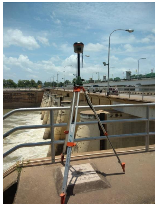
รูปที่ 4 ตั้งเครื่องรับสัญญาณดาวเทียมเหนือสถานีหลักหมุด BMR9
