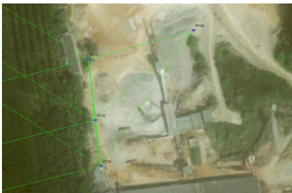
รูปที่ 4 โครงข่ายดาวเทียมหมุดในโครงการยึดโยงมายัง SNI-0043 SNI-0046
