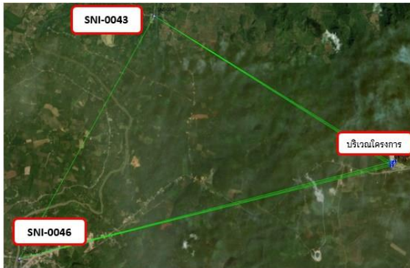
รูปที่ 3 โครงข่ายดาวเทียม SNI-0043 SNI-0046 ยึดโยงมายังหมุดในโครงการ
