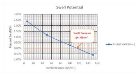
รูปที่ 7 ผลการทดสอบ Swell Potential ของดินที่ระดับความลึก 0.50 ถึง 0.90 เมตร
