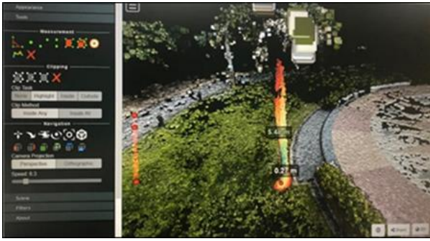
รูปที่ 8 หาปริมาตรของต้นไม้จาก 3D model โดยซอฟต์แวร์ OpenDroneMap
