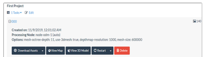
รูปที่ 7 การนำเข้ารูปภาพที่ได้จากการบินสำรวจ จำนวน 140 รูป ลงในคอมพิวเตอร์
