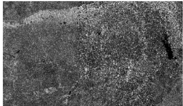
รูปที่ 1 การปรับปรุงคุณภาพด้วยวิธี Lee Filter ขนาด 3 x 3
