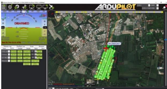
รูปที่ 5 การวางแผนบินถ่ายภาพสำหรับระบบกล้องชุดถ่ายภาพเดี่ยว
