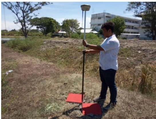
รูปที่ 9 การรังวัดค่าพิกัดจุด GCP ด้วยวิธีการ RTK
