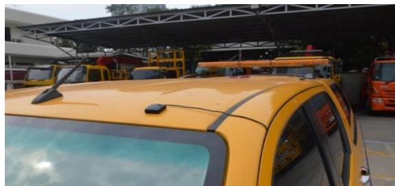
ก. ตัวอย่างการติดตั้ง GPS บนยานพาหนะทดสอบ
