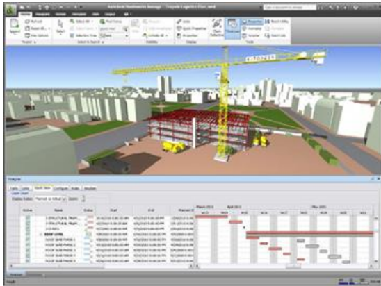
ที่มา : (สมาคมสถาปนิกสยามในพระบรมราชูปถัมภ์ , 2558 : 6) รูปที่ 3 การนำ BIM ไปใช้ในการบริหารงานก่อสร้าง
