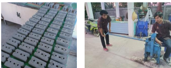
รูปที่ 5 การฝังตัวอย่างในร่มและการอัดขึ้นรูป
