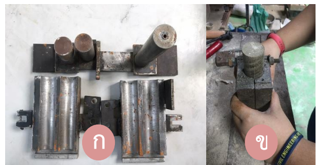
รูปที่ 1 ก) แบบหล่อ (Mold) ข) ตัวอย่างที่ใช้ในการทดสอบ
