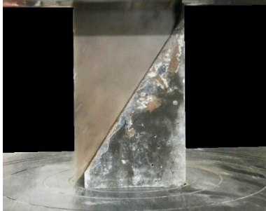
รูปที่ 6 ลักษณะการวิบัติของแท่งตัวอย่างจีโอโพลิเมอร์คอนกรีต
