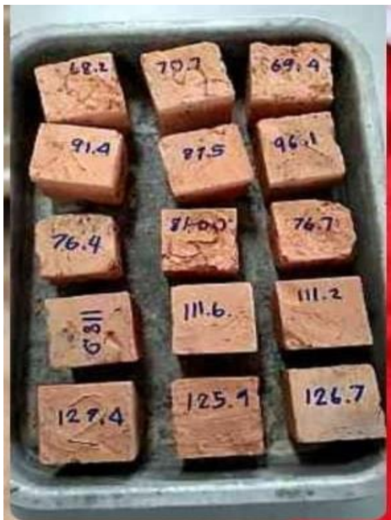
รูปที่ 4 แท่งทดสอบดินเหนียวมวลเบา
