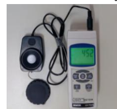
รูปที่ 4 เครื่องวัดความเข้มแสง Digicon LX-75SD
