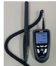
รูปที่ 3 เครื่องวัดปริมาณก๊าซคาร์บอนไดออกไซด์ Kimo AQ 200
