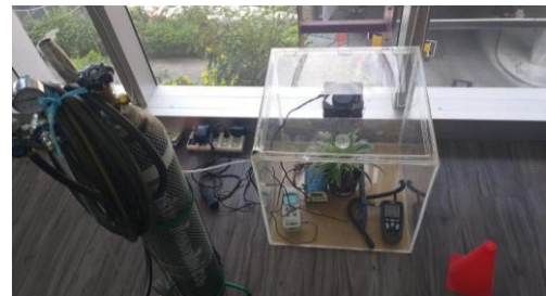
รูปที่ 11 การปล่อยก๊าซ CO 2 เข้าไปในกล่องทดลอง
