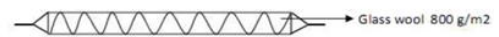
รูปที่ 7 วัสดุเส้นใยในผนังของต้นแบบกำแพงกั้นเสียงชนิดสะท้อนเสียง
