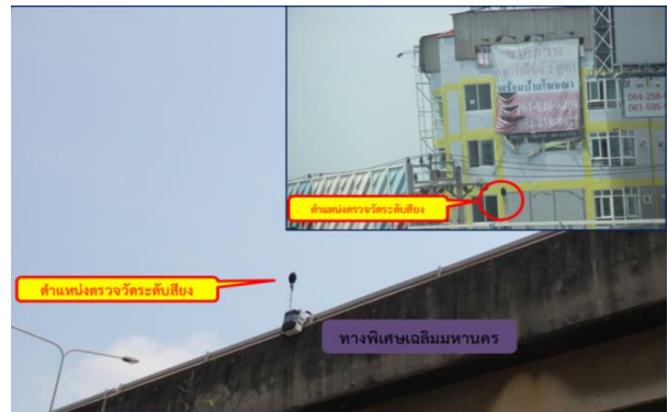
รูปที่ 17 การตรวจวัดระดับเสียงบริเวณที่ไม่มีกำบังติดตั้งกำแพงกันเสียง
