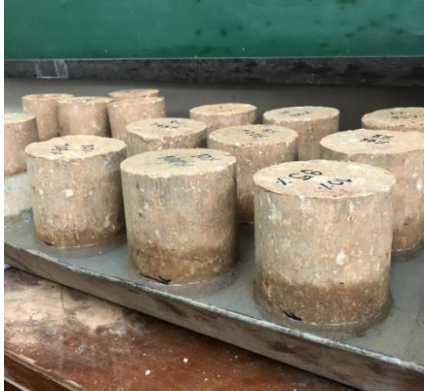
รูปที่ 9 ตัวอย่างทดสอบการดูดซึมน้ำ
