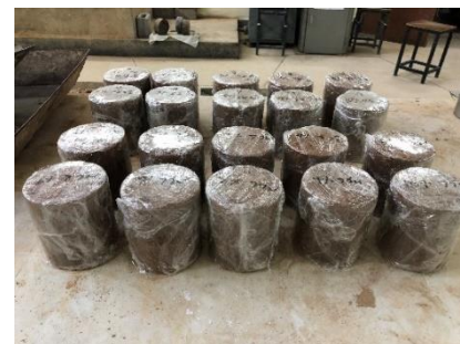
รูปที่ 4 ก้อนตัวอย่างดินลูกรังที่ปรับปรุงด้วยวัสดุผสมซีเมนต์-โพลีเมอร์
