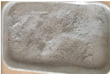
รูปที่ 4 ปูนซีเมนต์ปอร์ตแลนด์ประเภทที่ 1
