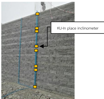
รูปที่ 8 อุปกรณ์วัดการเคลื่อนตัวของกำแพง KU-In place inclinometer
