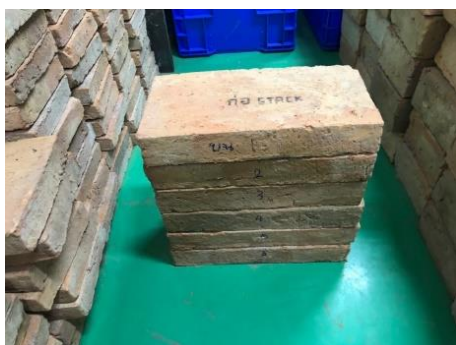
รูปที่ 3 อิฐก่อรูปแบบปริซึม (Masonry prism)
