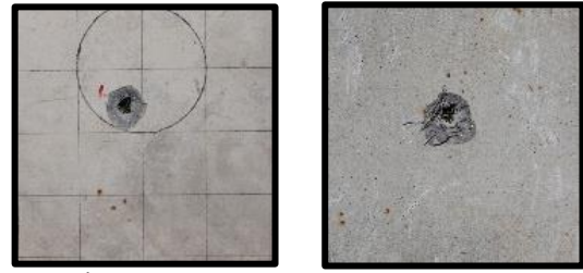
รูปที่ 5 การวิบัติ แบบ Perforation (ด้านหน้าและด้านหลัง)
