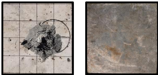
รูปที่ 11 การวิบัติ แบบ Penetration + without back damage (ด้านหน้าและด้านหลัง)
