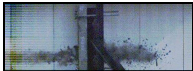
รูปที่ 8 ภาพถ่ายความเร็วสูงของการวิบัติ แบบ Perforation + flying debris
