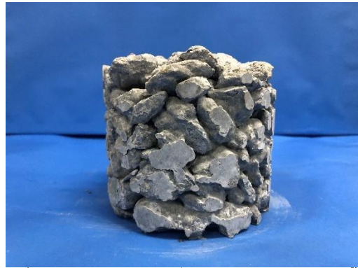
รูปที่ 5 ตัวอย่างคอนกรีตพรุนที่ใช้ในการทดสอบการซึมผ่านน้ำ
