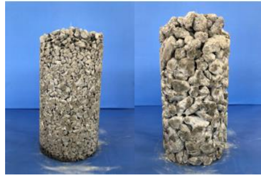
รูปที่ 3 ตัวอย่างคอนกรีตพูนที่ใช้ในการทดสอบกำลังอัด
