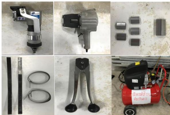
รูปที่ 1 อุปกรณ์สำหรับเสริมโครงสร้างคอนกรีตด้วย Post-tensioned metal strapping (PTMS) (อ้างอิงจาก [7])
