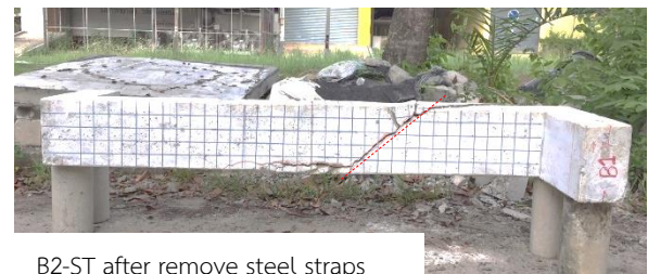
รูปที่ 5 ภาพการวิบัติของตัวอย่างคานทดสอบ
