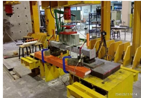
รูปที่ 2 การจำลองการติดตั้งการทดสอบคานช่วงเดียว
