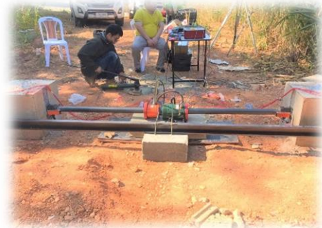
รูปที่ 6 การทดสอบเสาเข็ม
