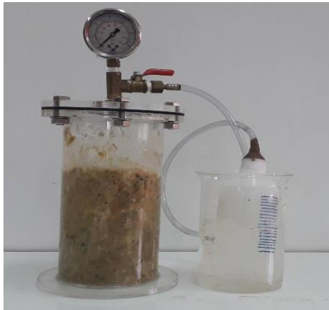
รูปที่ 1 ชุดถังหมักก๊าซชีวภาพ ขนาด 1.5 ลิตร
