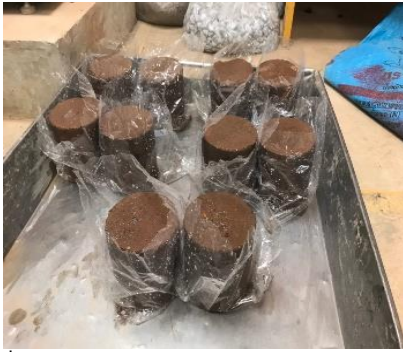
รูปที่ 14 ตัวอย่างสำหรับการทดสอบหาค่ากำลังอัดแกนเดียว
