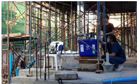
รูปที่ 7 อุปกรณ์และการทดสอบ Thermal Response Test
