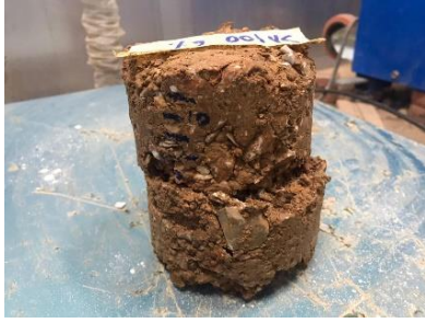
รูปที่ 9 ตัวอย่างหลังจากการทดสอบการดูดซึมน้ำในมวลดิน
