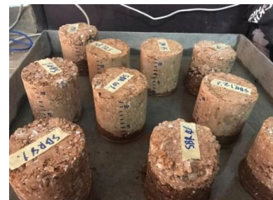
รูปที่ 8 ทำการทดสอบแช่น้ำเป็นเวลา 72 ชั่วโมง
