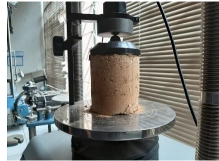
รูปที่ 6 การทดสอบเพื่อหาค่าแรงอัดแกนเดียว
